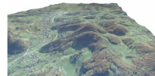
Slika 21: Kombinirana uporaba podataka digitalnog modela reljefa i digitalne ortofotokarte
